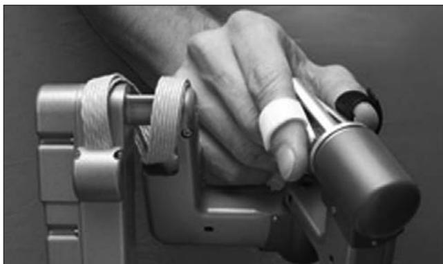
Fig. 8. Mangos para manipulación del instrumental quirúrgico (detalle).
