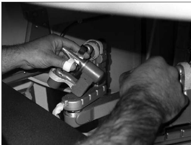
Fig. 7. Mangos en la consola maestra para manipulación del instrumental quirúrgico.
