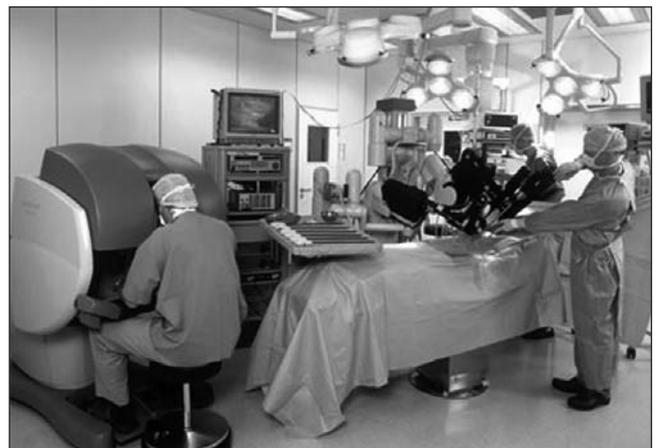
Fig. 4. Robot Da Vinci. Consola maestra y brazos robóticos.
