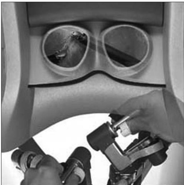
Fig. 5. Binoculares en la consola para visión estereoscópica de alta resolución.
