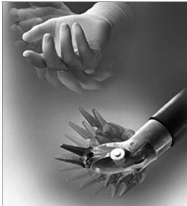
Fig. 11. Instrumental articulado utilizado por el robot *Da Vinci*.
