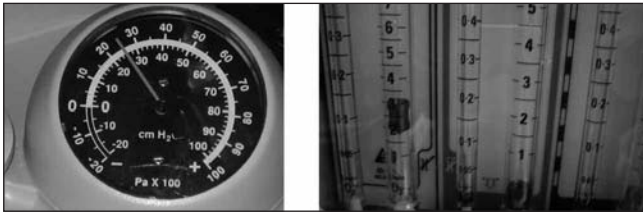
Fig. 12. Determinación de la presión de sellado.
